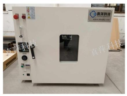
超高真空烘箱被广泛应用于航空、航天、电子、通讯等科研及生产单位。确定仪器仪表、电工产品、材料、零部件、设备等在低气压、高温单项或同时作用下的环境适应性与可靠性试验。下面为大家介绍一下超高真空烘箱的主要技术指标。1. 工作室温度范围: 常温~+300℃用户使用温度260℃2. 温度波动度: ±1.0℃(空载); 3. 温度偏差: 常压温度试验: 常温~200℃时±2℃200~300℃时±5.0℃低气压高温综合试验: ≤100℃时±2.0℃,100℃~200℃时±5.0℃200℃~300℃时±7.0℃上海存储柜的发展趋势。江苏存储柜维修
